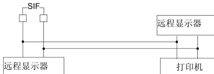
图例所示为连接外部显示的例子。每个显示器都可以根据设定,显示各自内容。
