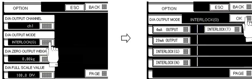
4) 点击 D/A 零点输出重量
